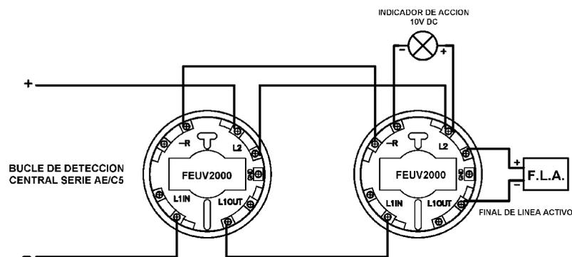
**Observaciones:** La activación simultánea de 2 o más detectores, puede sobrepasar el límite de corriente máximo permitido en el bucle de detección (120 mA), provocando la desconexión de la alimentación, y que los indicadores de los detectores activados se apaguen.
